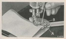
FIG. 44. ADJUSTING THE BINDER
